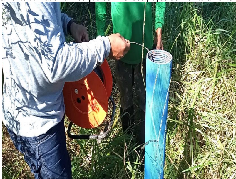
Figura 3 - Equipamento utilizado na medição do nível dos poços de monitoramento.
