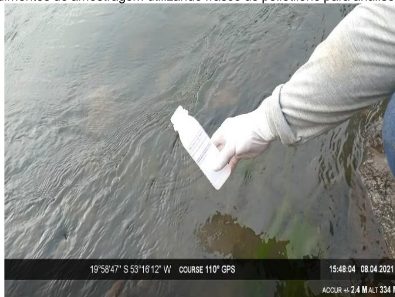
Figura 3 - Procedimentos de amostragem utilizando frasco de polietileno para análises físico-químicas.
