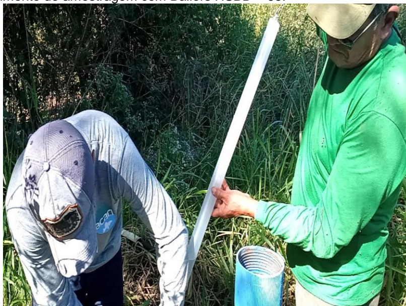
Figura 4 - Procedimento de amostragem com Bailers HSBD – 95.
